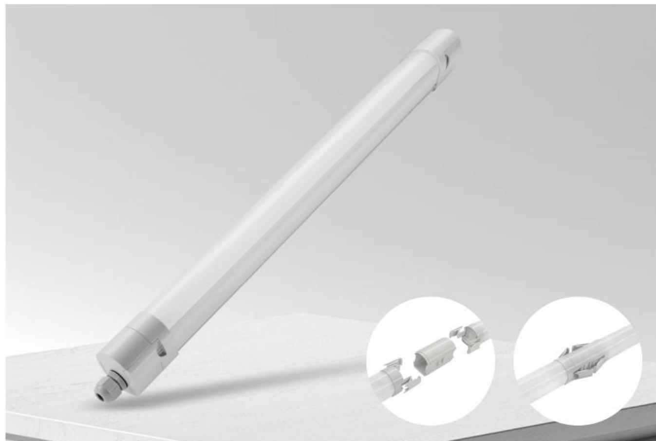
Modello: YL20-36W-F/YL20-36W-N Potenza: 36W Lumen: 3960LM Temperatura di colore: 6500K/4000K Fascio luminoso: 120° Materiale: PC Dimmer: NO Cri(RA): \geq 80 Tensione di ingresso: AC 220-240V 50/60Hz IP Protezione: IP65 Driver provided by: Philips LED provided by: Philips
